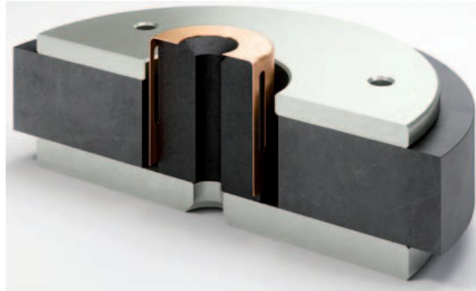
Der Polkern besteht aus dem Mixstoff Soft Magnetic Compound (SMC). Die Ferritpartikel werden isoliert voneinander eingelagert, was Wirbelstromverlusten entgegenwirken und zugleich die Magnetfelder idealisieren soll. Zudem wird der gebohrte Polkern noch von einer Manschette aus Kupfer umschlossen.
