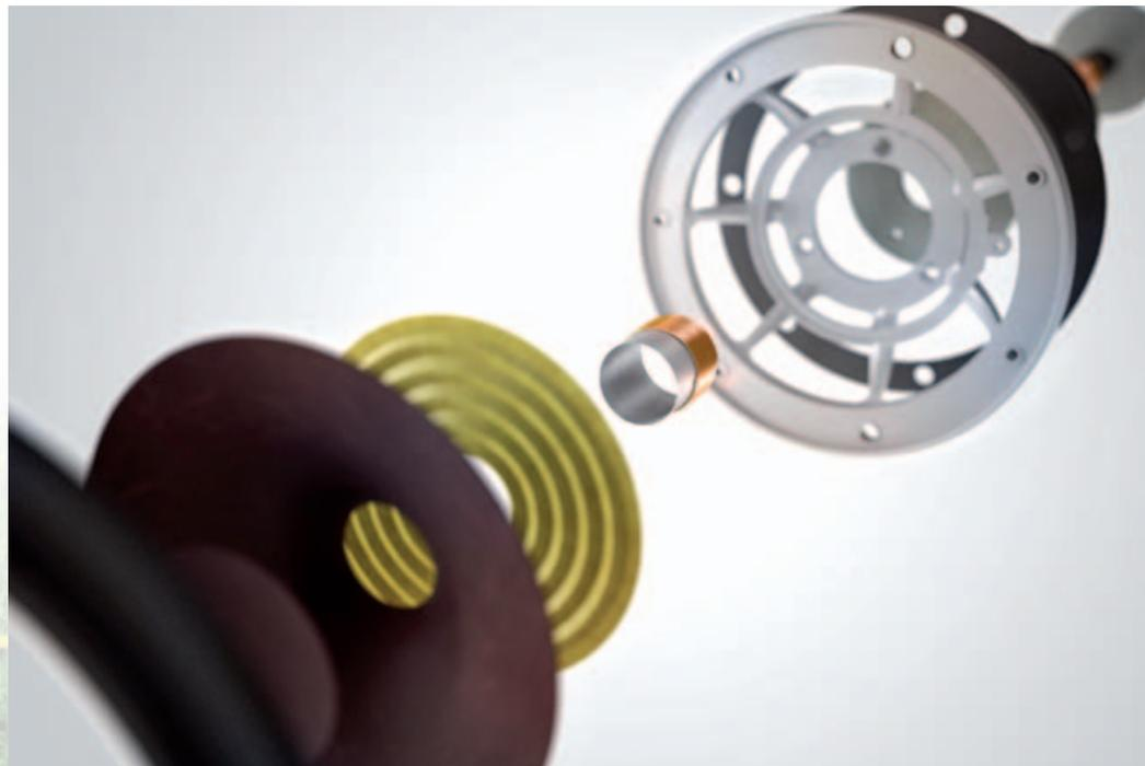
Die Gesamtkonstruktion des Tief/Mitteltöners wird von einem Chassis-Korb aus massivem Aluminium gehalten. In die rot schimmernde Membran mixen die Dänen Holzfasern – die mit ihrer chaotischen Verteilung Eigenresonanzen der Membran entgegenwirken sollen.
