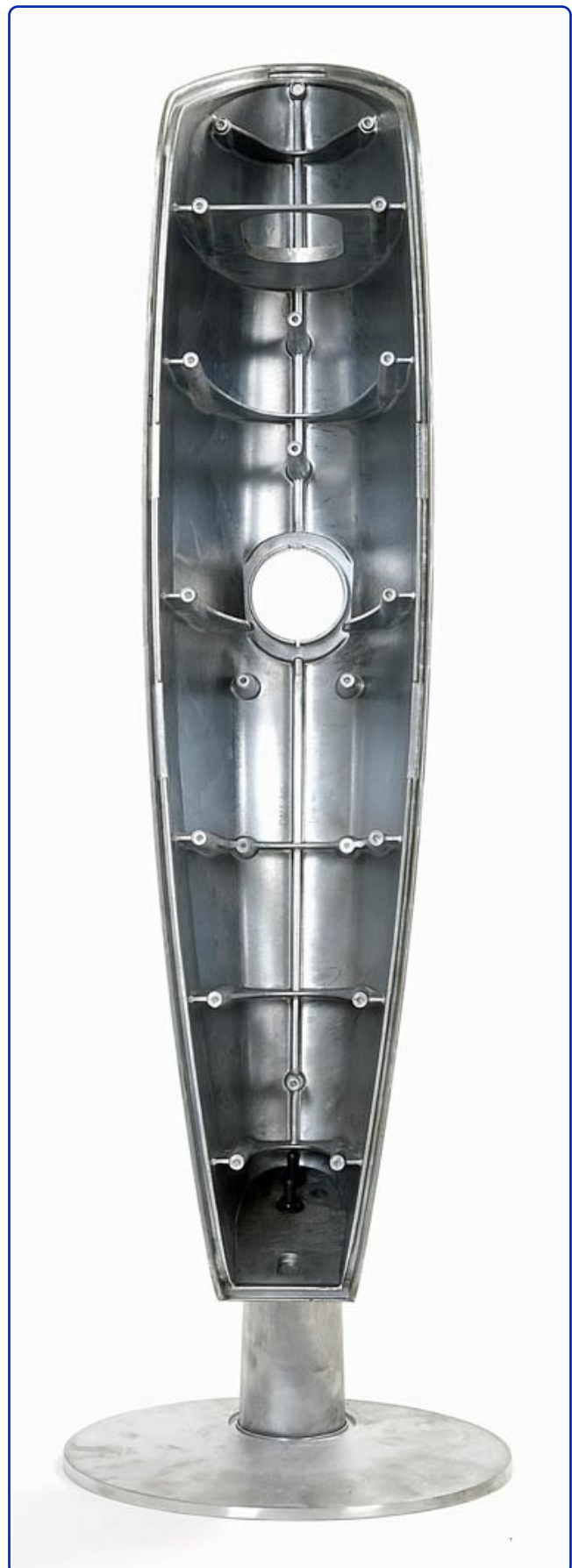
Die Fazon F5 als Aluminium-Rohling: Bis diese Form serienreif wurde, verging eine Menge Zeit. Dass der Lautsprecher dabei relativ preiswert geblieben ist, spricht für das Know-how im Hause Dali. (Bild: Dali)
