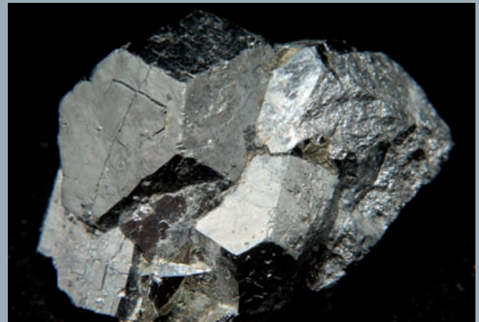
Kobalt – hier in seiner Rohform als Skutterudit – ist ein seltenes Element, das nur in Verbindung mit anderen Metallen als Erz vorliegt. Es ist für AlNiCo-Magnete wie auch SmCo essenziell. Es zählt aber aufgrund seiner Position im Periodensystem nicht wie Samarium und Neodym zu den seltenen Erden.
