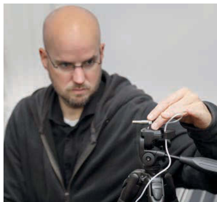
▲ Zum Einfangen der Raumakustik platziert wird das Mikrofon in Ohrhöhe direkt am Hörplatz.
