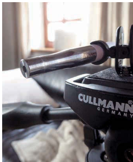
▲ Das Kugelköpfchen i436 von MicW erwies sich als zuverlässiger mobiler Mess-Begleiter.
