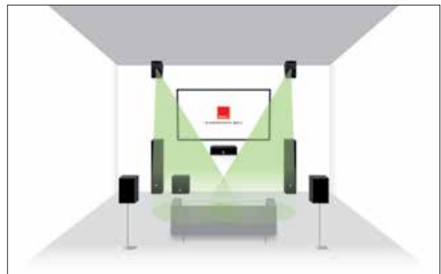
Der DALI ALTECO C-1 an der Frontwand unterhalb der Decke als nach unten abstrahlender Lautsprecher für die Höhenkanäle eines 5.1.2-Heimkinosystems
