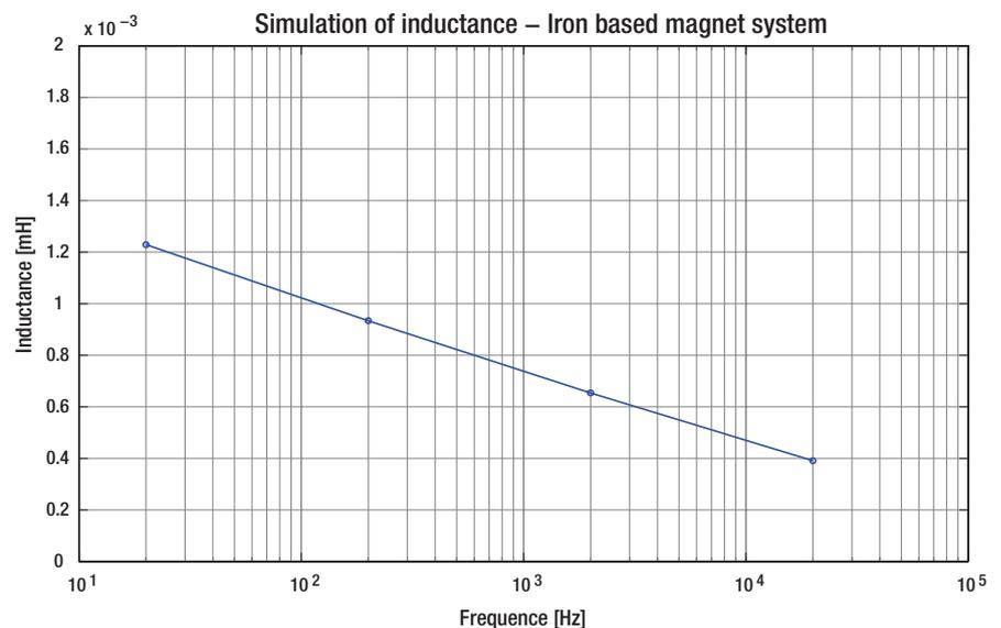
traditionellen Magnetsystem mit weichem Eisen mit einem identischen physikalischen Aufbau mit SMC-Komponenten dargestellt.
