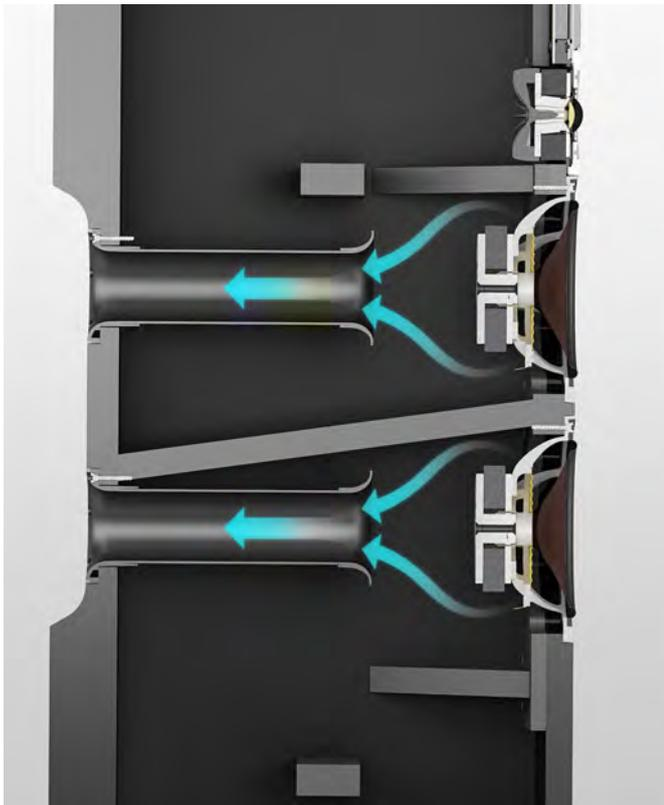
*DALIs Zielsetzung war es schon immer, den Zeitversatz zwischen Treiber und Bassreflex-Öffnung zu minimieren. Mit einer Anordnung der Reflexöffnungen in der Nähe der Tieftöner erreicht man eine möglichst direkte Verbindung. Je weniger Verzögerung, desto besser das Timing – und umso genauer das Impulsverhalten.*
