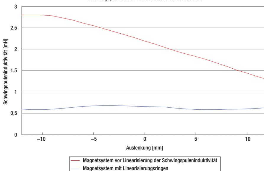
Die untere Kurve zeigt die Schwingspuleninduktivität als eine Funktion des Hubs, im Vergleich zu einer identischen Konstruktion ohne Linearisierungsrings (obere Kurven). Das untere Diagramm zeigt den Tieftöner der EPICON 8, das obere den Tiefmitteltöner der EPICON 6.
