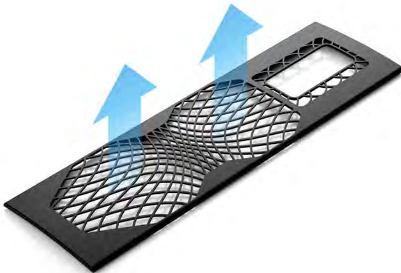
*Selbst das Layout des Abdeckgitters war Gegenstand ausführlicher Experimente. Es gibt keine gleichgroßen Löcher, was dazu führt, dass der Stoff absolut plan und frei von möglichen Störgeräuschen auf dem Lochblech aufliegt. Bei einer Vielzahl von gleichgroßen Löchern würde der Abdeckstoff vibrieren, da der Luftstrom durch jedes Loch identisch wäre.*
