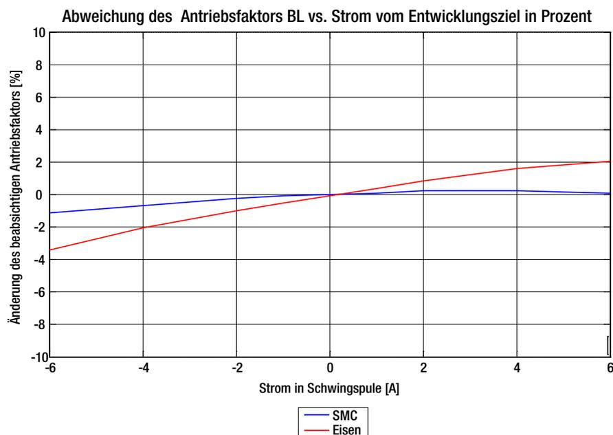
Eine substantielle Reduzierung der durch den Strom verursachten Modulation des Flusses lässt sich indes nur durch den Einsatz von nicht-leitenden Materialien in der Nähe des Magnetspalts erreichen, da sich dieser Teil des Magnetsystems (bedingt durch seinen konstruktiven Aufbau) direkt an der Schwingspule befindet.
