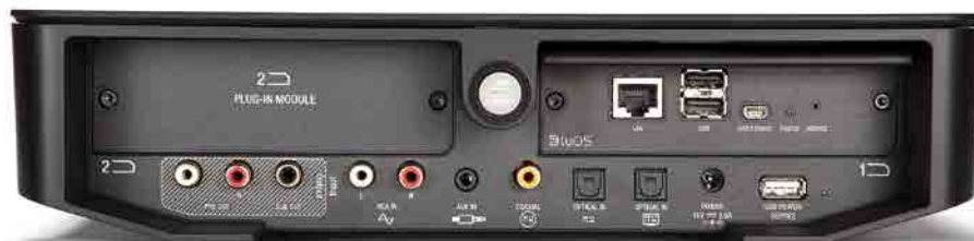
▲ Die Steuereinheit verfügt über digitale und analoge Eingänge und Ausgänge, das optionale Streaming-Modul ist Roon-ready.
