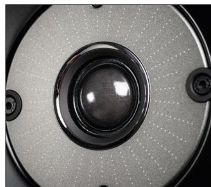
Die 29mm messende Gewebekalotte überzeuget durch detailreiches Aufspielen
