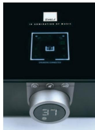
Kleine Bildschirme auf der Oberseite des SoundHubs und der Rückseite der Lautsprecher erleichtern die Einrichtung des Wireless-Lautsprechersystems. Dali setzt konsequent auf eine Drahtlos-Verbindung, es gibt keine Ethernet-Buchsen an den Lautsprechern.
