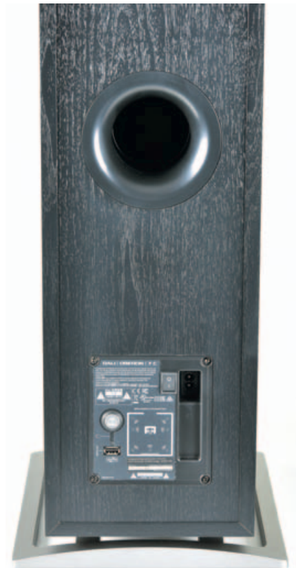
Da ist das Kraftwerk: Hinter dem Terminal liegt ein digitaler Amp mit doppelten 50 Watt.
