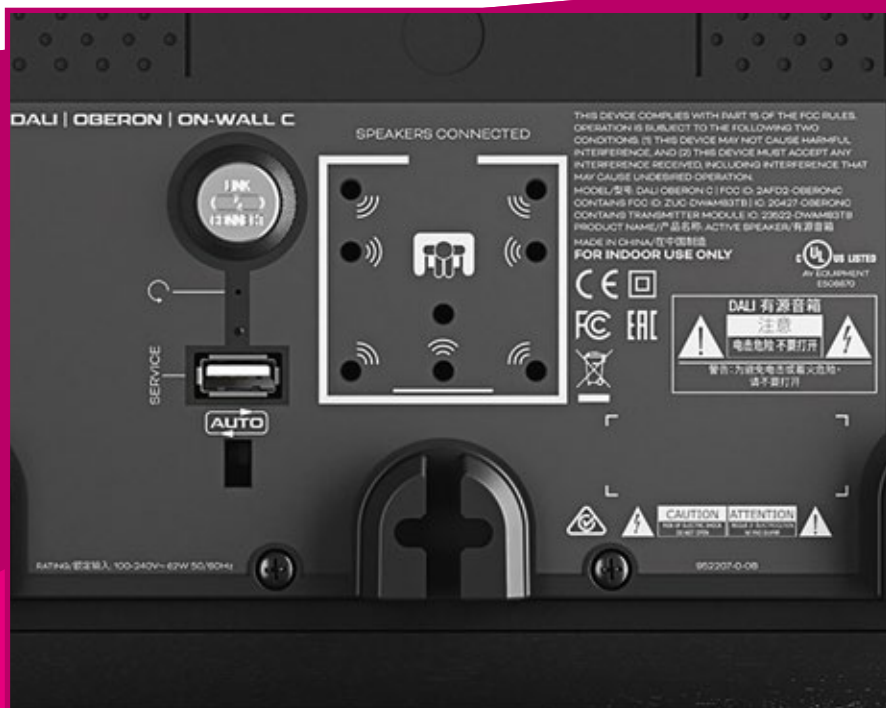
Über das rückseitige Bedienfeld lassen sich die On-Wall C koppeln und in ihrer Funktion zuweisen. Bis zu 7.1 Surround ist so ohne Signalkabel möglich
