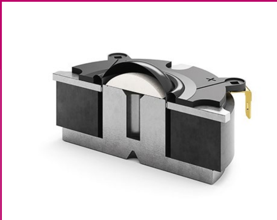
Der Hochtöner der Oberon On-Wall C ist mit einer besonders leichten und mit 29 mm Durchmesser ungewöhnlich großen Kalotte ausgestattet
