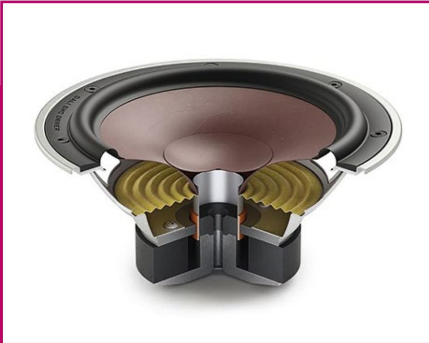
Die Membran der 130 mm großen Oberon On-Wall C Tiefmitteltöner besteht aus einem proprietären Materialmix; einem Verbund aus Papierzellstoff und Holzfasern
