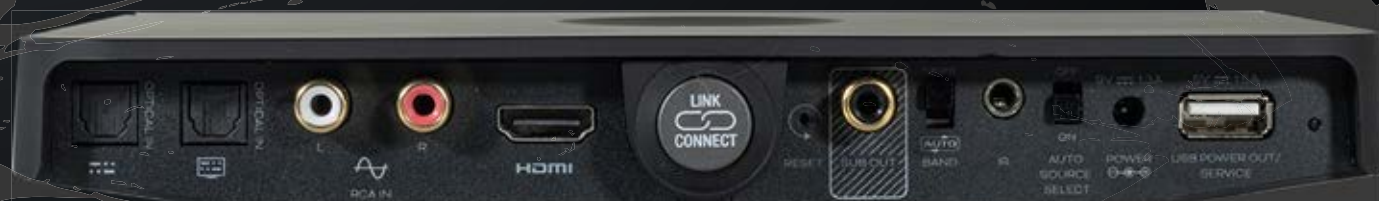
Der Sound Hub Compact unterscheidet sich vor allem ob des Verzichts auf die Steckplätze für BluOS- und HDMI-Modul von der größeren Variante. Die Ausstattung ist dennoch ebenso ansprechend und hochwertig ausgeführt. Zentral sehen wir den Link Connect-Button
