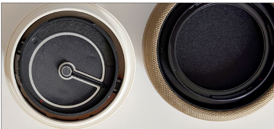
Links sieht man das verwendete Chassis, das bis auf den Werkstoff SMC für den Antrieb vom Top-Modell IO-12 stammt. Rechts das abnehmbare Ohrpolster aus Leder.
